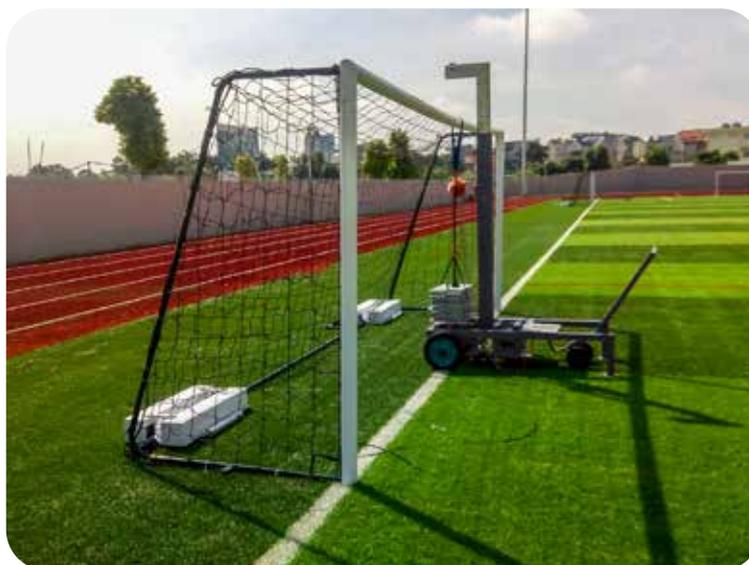
Afin de satisfaire aux exigences de sécurité présentes au Code du sport, Sodex propose une machine de test livrée avec dynamomètre, palan, chaîne, contrepoids et roues pneumatiques.
