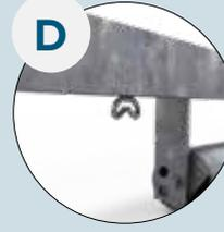
Crochets soudés en bas des arceaux. Évitent au filet de tomber sur les rouleaux
